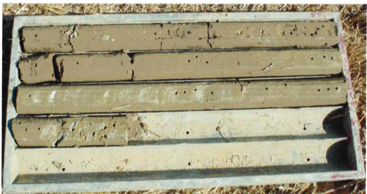
CASSETTA n°2: carote prelevate alle profondità 5 - 8,3 metri
