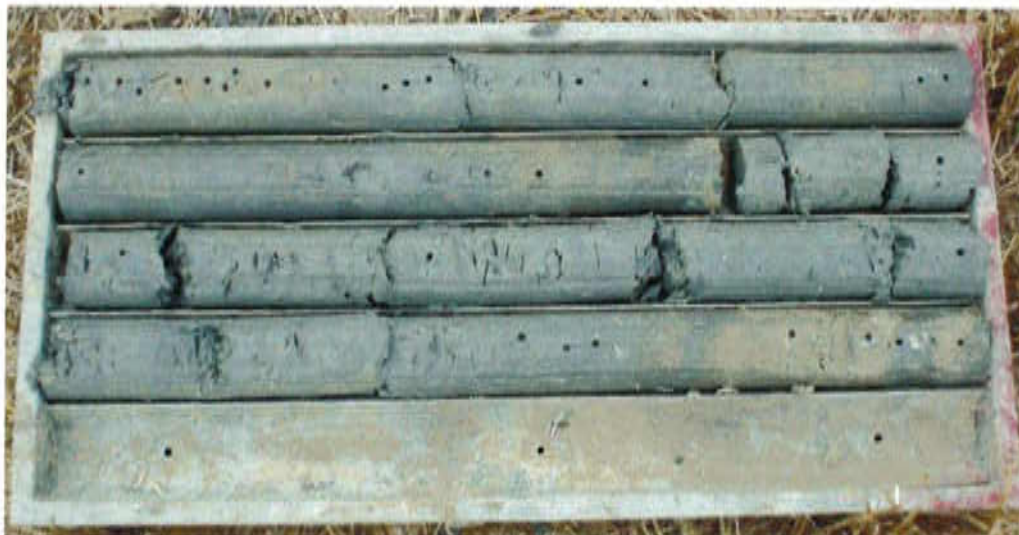
CASSETTA n°3: carote prelevate alle profondità 10 - 14 metri
