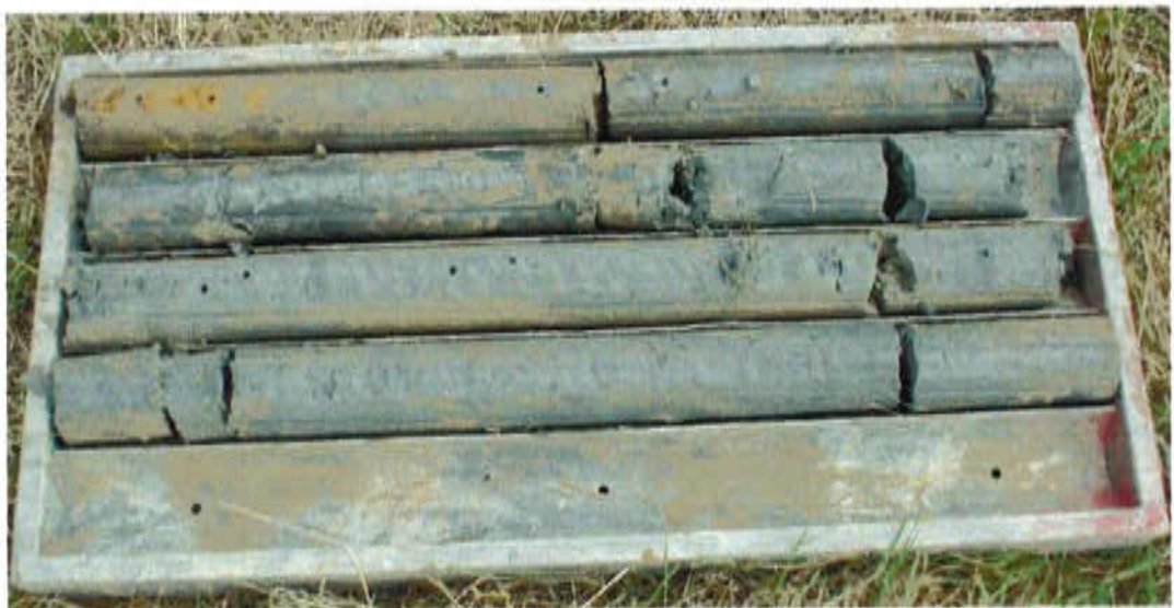
CASSETTA n°3: carote prelevate alle profondità 10 - 14 metri
