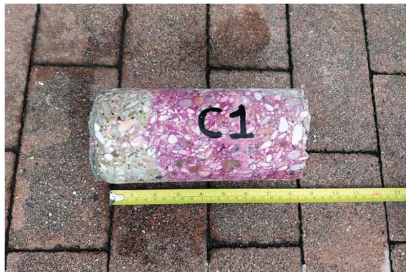
Foto n. 2 Determinazione della profondità della carbonatazione su provino "C1"
