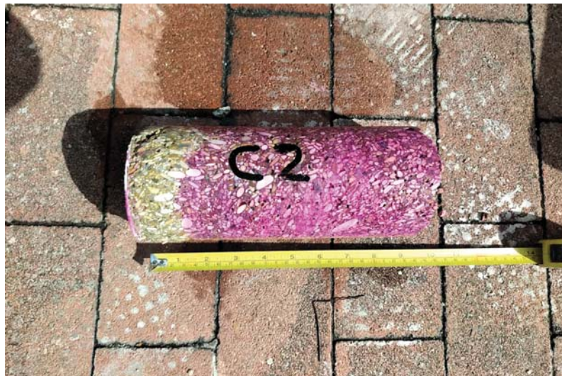
Foto n. 6 Determinazione della profondità della carbonatazione su provino "C2"
