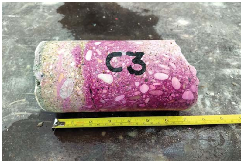
Foto n. 10 Determinazione della profondità della carbonatazione su provino "C3"
