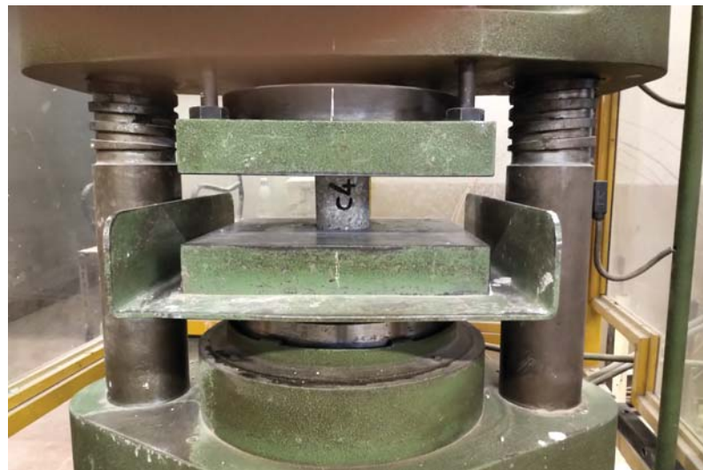
Foto n. 14 Prova di compressione su provino cilindrico di calcestruzzo "C4"
