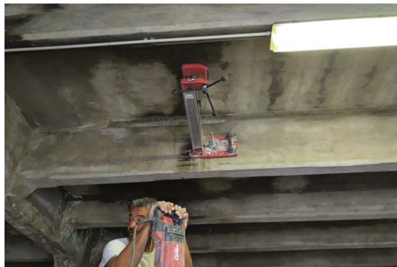
Foto n. 12 Prelievo di provino cilindrico di calcestruzzo "C4" da trave interna (locale Banchina da Chio 8)
