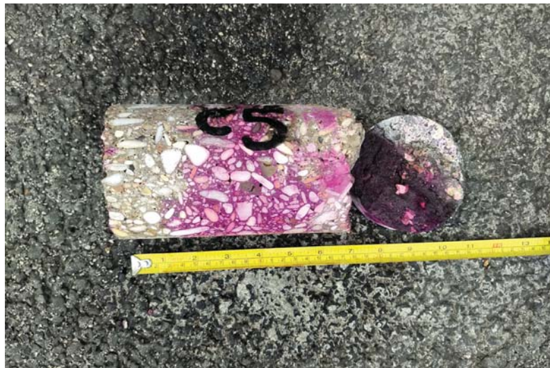
Foto n. 16 Determinazione della profondità della carbonatazione su provino “C5”
