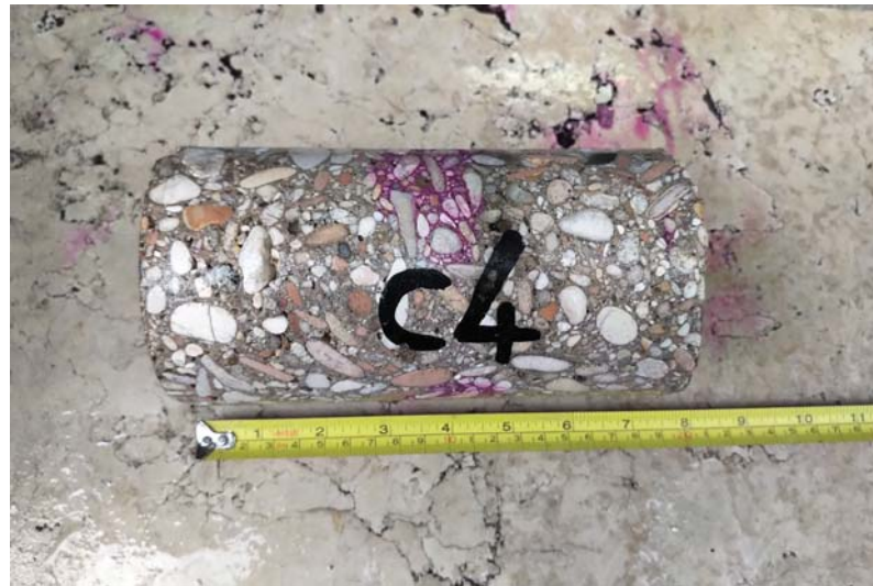
Foto n. 14 Prova di compressione su provino cilindrico di calcestruzzo "C4"
