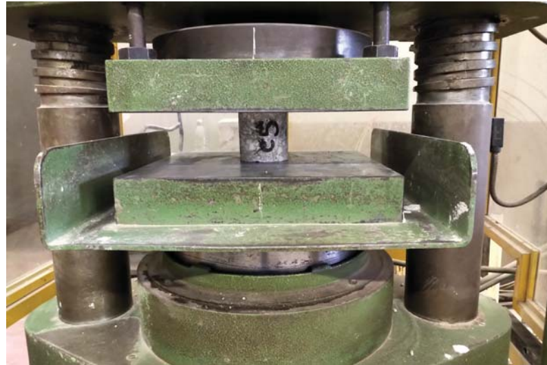
Foto n. 17 Prova di compressione su provino cilindrico di calcestruzzo "C5"
