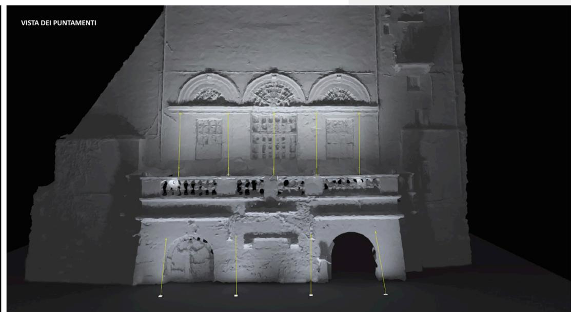
L'edificio è illuminato da due postazioni: il registro inferiore della facciata, caratterizzato dai due piccoli archi e coronato dalla balaustra, è illuminato dal basso con apparecchi ad incasso a terra; il registro superiore del prospetto è illuminato dal basso, con proiettori installati a pavimento sulla balconata, tutti con ottica Wall Washer.
