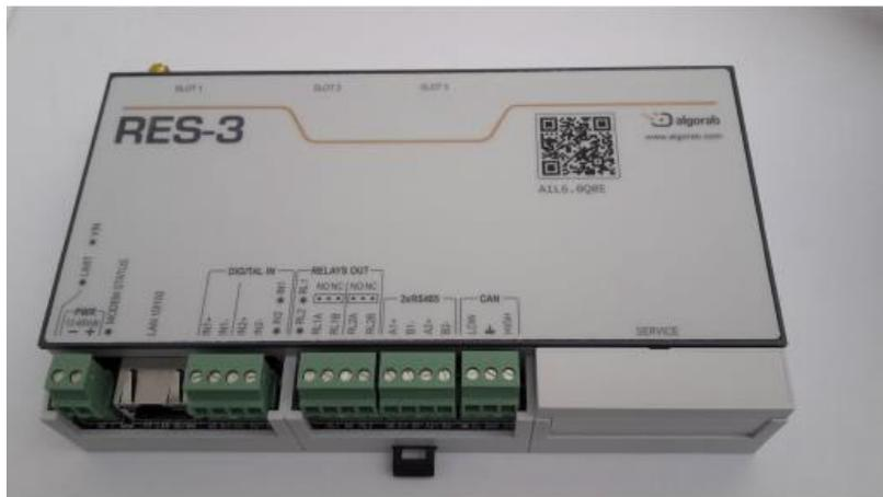
Dispositivo programmabile a microprocessore, dotato di sistema operativo Linux, da utilizzare per applicazioni di telecontrollo, automazione, comunicazione di campo, comunicazione verso il centro di controllo, in grado di gestire canali di comunicazione “wired” e “wireless”.
