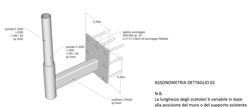
NB: i bulloni dovranno essere dotati di dispositivi antisvitamento: rondelle elastiche spaccate secondo la UNI 1751:2013, in aggiunta alle rondelle tradizionali
