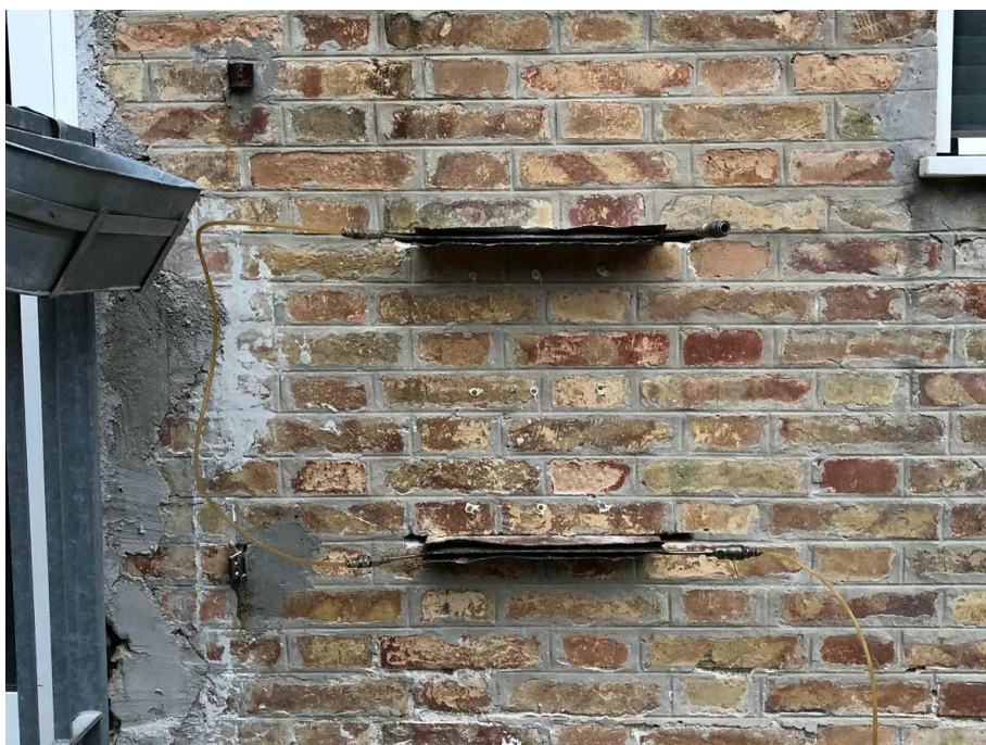
FOTO 6 – Piano Terra. Prova con Martinetto Piatto Doppio MPD
