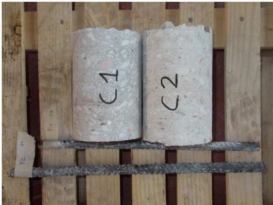
FOTO 3 – Campioni di calcestruzzo e barre di armatura prelevati
