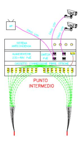
le temperature estive ed invernali massime e minime che potranno esserci, è richiesto che gli switch per montaggio all'esterno siano in grado di lavorare in un range di temperatura da - 40 a + 70°C.
