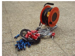
Avvolgicavo per 12 canali, 12 Geofoni. 4.5Hz
