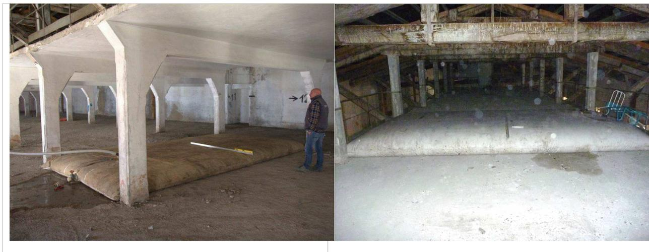
Figura 50 - Disposizione carico soletta quota +10.55 m e quota +13.30 m
