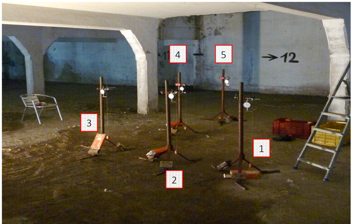
Foto 4.4 Posizione dei sensori di spostamento
