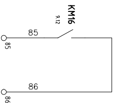
POMPA IN MARCIA E.P. CIRCUITO SECONDARIO ACQUA DI MARE
