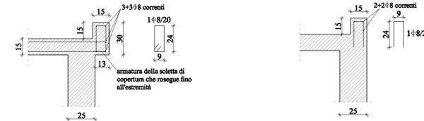
PARTICOLARE ANTERIORE e POSTERIORE A LIVELLO DI PIANO
