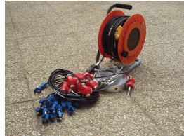
Avvolgicavo per 12 canali, 12 Geofoni. 4.5Hz
