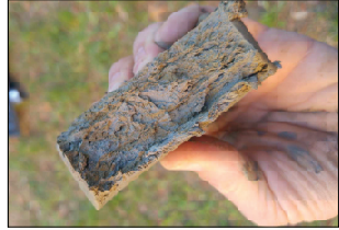
FOTO 3-4: A sinistra un particolare della coltre colluvio-eluviale limoso-sabbiosa ed argillosa (-3.0 m), mentre nella foto a destra un particolare della formazione delle argille azzurre (-8.0 m).
