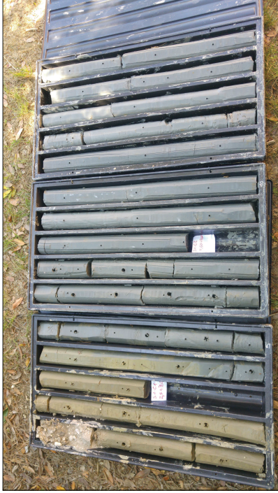
FOTO 2 - SONDAGGIO S: Ogni carota di terreno rappresenta un metro di profondità, a partire dall'alto a sinistra verso destra. Il sondaggio è terminato ad una profondità di circa 15 metri dal p.c. nella formazione delle argille azzurre. Il campione n.1 è stato prelevato da 2.5 m a 3.0 m, mentre il campione n. 2 da 7.6 m a 8 m dal p.c.
