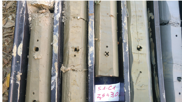
Figura 9: Particolare delle prove Poket Penetrometer e Vane Test nelle carote
