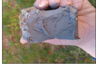
FOTO 3-4: A sinistra un particolare della coltre colluvio-eluviale limoso-sabbiosa ed argillosa (-3.0 m), mentre nella foto a destra un particolare della formazione delle argille azzurre (-8.0 m).
