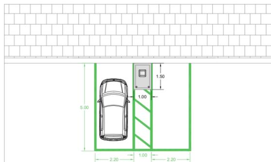
Tipologia di installazione C: vista in pianta
