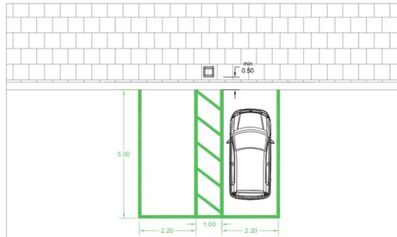
Tipologia di installazione A: vista in pianta
