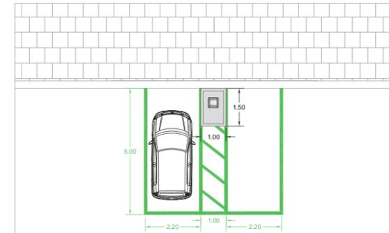
Tipologia di installazione B: vista in pianta
