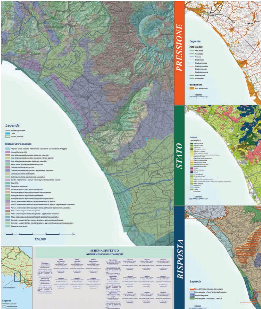
Figura 1 – Modello DPSIR per l'Analisi antropico ambientale delle pressioni antropiche (strade ed insediamenti) esercitate sullo stato ambientale (uso del suolo) e le risposte (aree poste a protezione) relative al tratto di costa compreso tra il fiume Garigliano e il fiume Volturno, Campania Settentrionale
